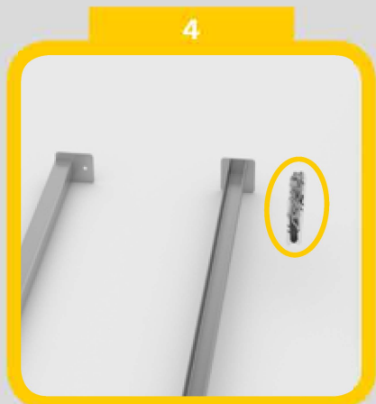
Z jedné distanční vzpěry vyjměte spojovací materiál
