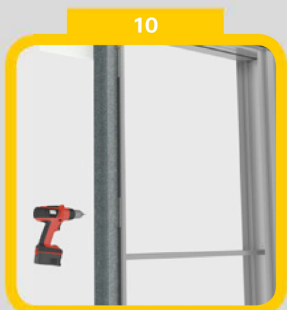
Přišroubujte pouzdro přes kotvící plochy ke konstrukci SDK
