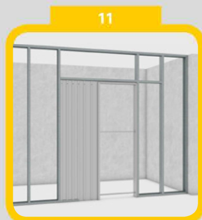
Usazené pouzdro v SDK konstrukci
